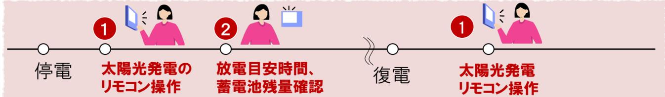
停電になると自動で蓄電池からの放電動作に切替わります。停電は、蓄電池のリモコンに「**停電時運転中**」の表示でご確認ください。
