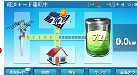
※蓄電池のパワーコンディショナーに接続された太陽光発電の発電量を表示します。
