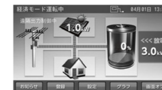
蓄電池リモコン画面
